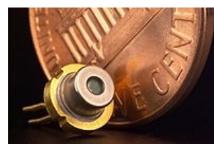
Laserová dioda v pouzdře, pro srovnání velikosti s dolarovým centem
