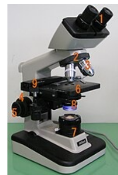
Hlavní součásti světelného mikroskopu: 1) okulár, 2) otočný revolver, 3) objektivy, 4) makrošroub, 5) mikrošroub, 6) stolek, 7) světelný zdroj, 8) kondenzátor a clona, 9) křížový posun
