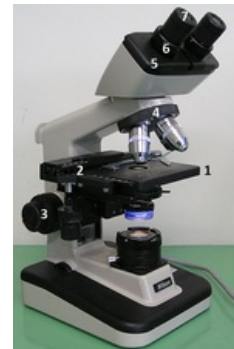
Mechanická soustava optického mikroskopu: 1) stolek, 2) křížový posun, 3) makrošroub a mikrošroub, 4) revolver, 5) tubus, 6) zaostřovací kroužek, 7) očníce.
