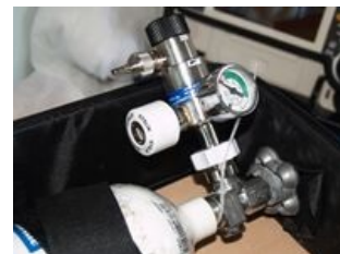
Redukční ventil s průtokoměrem
