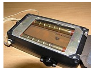
Ionizační komory v dozimetru
