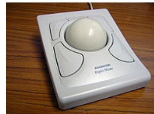
Trackball, vstupní zařízení, které může být v některých případech poruch pohybových schopností ovladatelné snáze než klasická myš.
